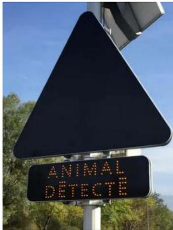
**Figure 5 : dispositif d'alerte clignotant (message + symbole animal sauvage)**
